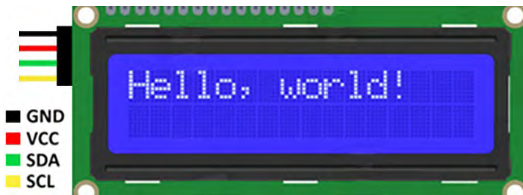
Рис. 1. Подключение модуля ЖКИ к Ардуино
